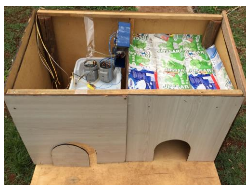
Figura 3. Montagem da maquete com equipamento para monitoramento das temperaturas dos ambientes internos e externo.
