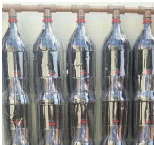
Figura 1: Montagem do aquecedor solar.
