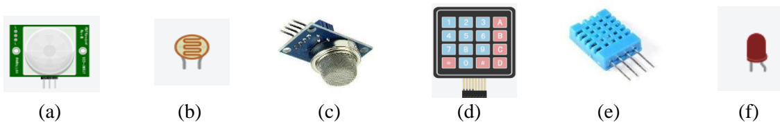
Figura 2 – Sensores do projeto: (a) Sensor de presença PIR, (b) Sensor de luminosidade, (c) sensor gás inflamável, (d) Teclado Matricial, (e) Sensor de Umidade e Temperatura – DHT11 e (f) Led.
