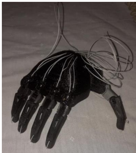
Figura 4 – Mão completa impressa em impressora 3D com filamento PETG.
