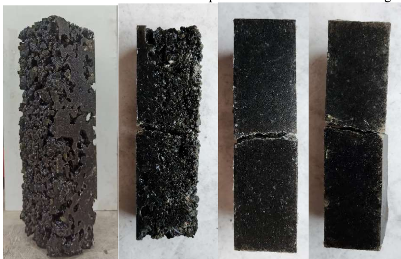
FIGURA 2. Da esquerda para a direita, as amostras com menor teor de resina, para a com maior teor.
