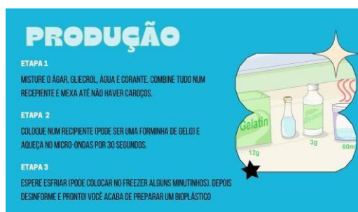
FIGURA 2. Etapas de produção do bioplástico caseiro,
