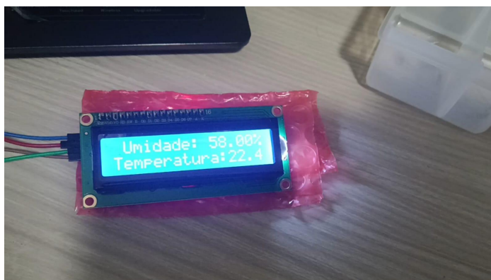
FIGURA 4. Valores de temperatura e umidade relativa do ar impressos no Display LCD
