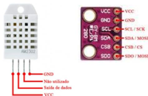
FIGURA 4. Sensor de umidade e temperatura do ar DHT22 (ou AM2302) e sensor de pressão e temperatura do ar BMP280.
