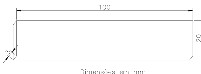
FIGURA 3. Dimensões do corpo de prova
