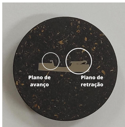
FIGURA 8. Parte do corpo de prova embutida em baquelite
