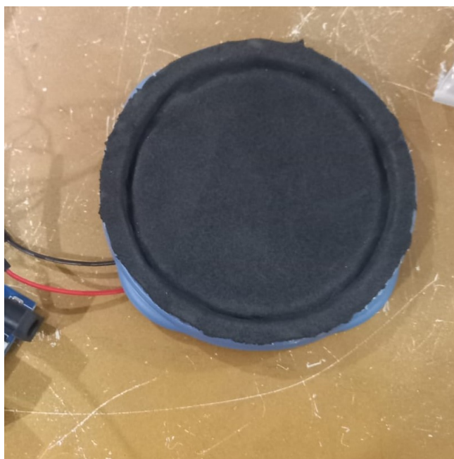
Figura 2: Isolando superficie com EVA
