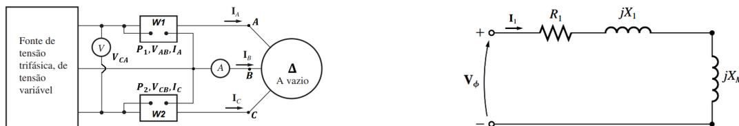
Figura 4: Ensaio a vazio, adaptado de Chapman (2013) e circuito equivalente correspondente.
