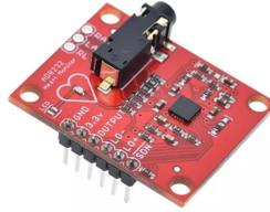
FIGURA 2. Imagem do módulo sensor ad8232.
