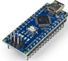
FIGURA 3. Imagem do arduino nano.
