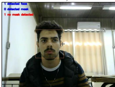
FIGURA 2. Foto com a distância máxima que o método Haar Cascade pode detectar a face (1 metro)
