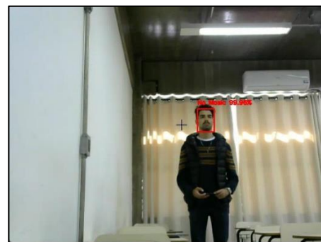
FIGURA 3. Foto com a distância máxima que o método DNN pode detectar a face (4 metros)
