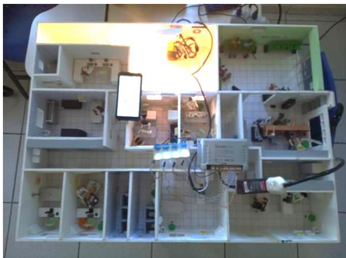
FIGURA 2. Demonstração de supervisório IoT com o Interruptor Sonoff. Fonte: próprio autor, ago 2022.
