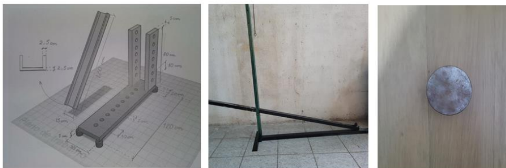
FIGURA 2: Primeira imagem à esquerda, projeto 3D do plano inclinado; segunda imagem, plano inclinado reclinável; terceira imagem, cilindro rígido homogêneo utilizado nos projetos.
