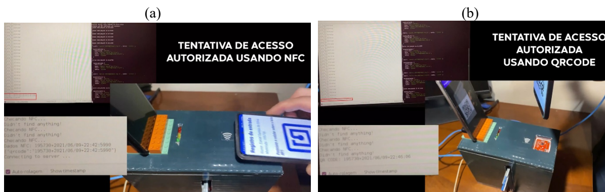
FIGURA 3. Testes finais realizados: (a) com leitor NFC, (b) com o dispositivo móvel para leitura de QRCode.
