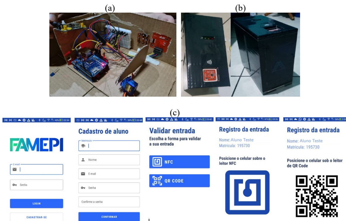
FIGURA 2. (a) Circuito montado do primeiro protótipo, (b) Protótipo final montado, (c) Telas do aplicativo de acesso
