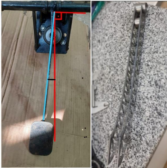
FIGURA 3: Pedais de freio: antigo e novo (autoria própria).
