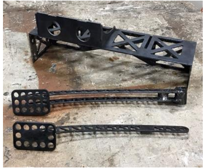
FIGURA 4: Montagem da caixa de pedais nova. (autoria própria)
