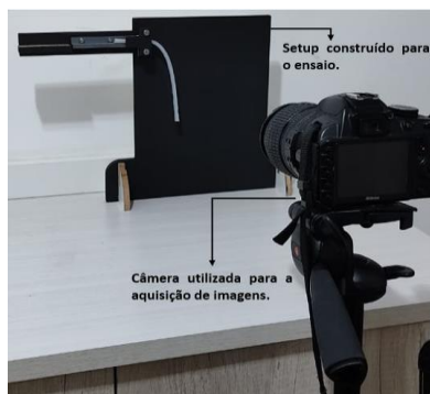
FIGURA 1. Estrutura do sistema para realização dos ensaios das vigas.
