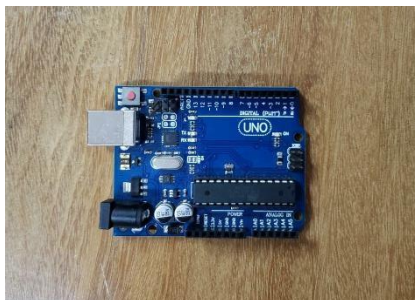
FIGURA 2. Arduíno UNO utilizado na estação medidora/transmissora.
