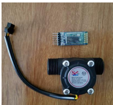
FIGURA 3. Sensor de vazão e módulo Bluetooth .
