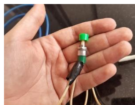
Figura 12 – Botão para acionamento. Fonte: Próprio autor.
