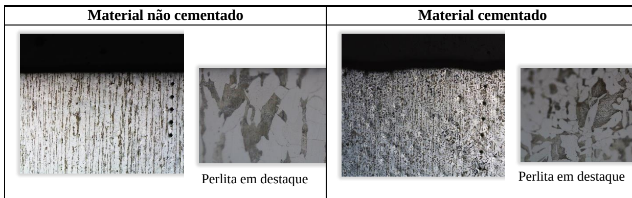
FIGURA 2. Metalografia com aumento de 50x e 500x, sendo submetido por 5 segundos em ácido níquel 2%.
