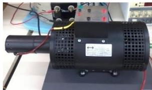
Figura 2: Motor de corrente contínua
