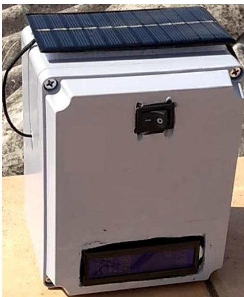
FIGURA 3. Medidor de Irradiância e Irradiação de Baixo Custo
