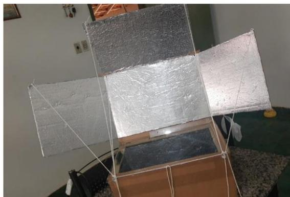
FIGURA 4. Forno solar pronto para ser utilizado.
