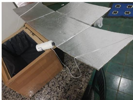
FIGURA 3. Fixação do refletor e revestimento interno.
