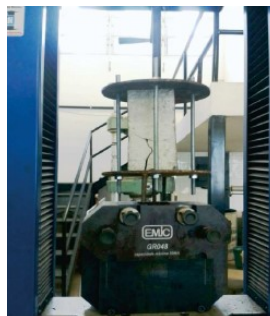
Figura 1 – Ensaio de arrancamento.
