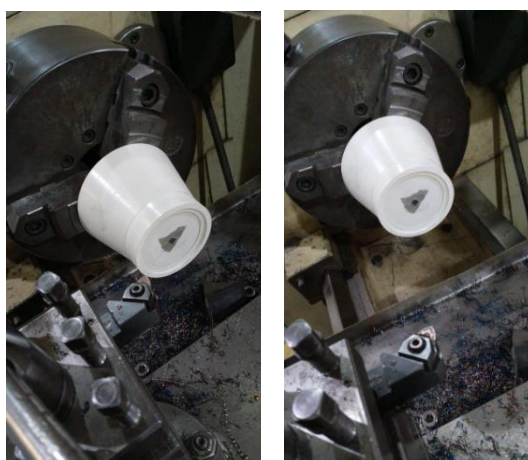
FIGURA 2. Sensor em fase de usinagem no torno mecânico.
