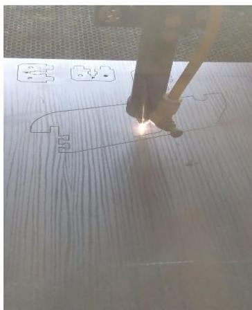
FIGURA 2. Realização do corte das peças na máquina de corte a laser – Fonte: os autores
