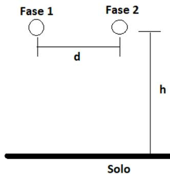
Figura 1: Representação de um linha de transmissão bifásica.
