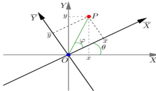
FIGURA 3. Rotação dos eixos
