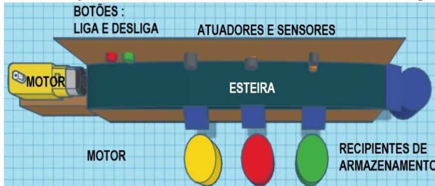
Mostra-se a posição do motor que movimenta a esteira, a posição dos sensores dos atuadores (cilindros pneumáticos) e o local dos recipientes para o armazenamento de cada um dos tipos dos materiais.
