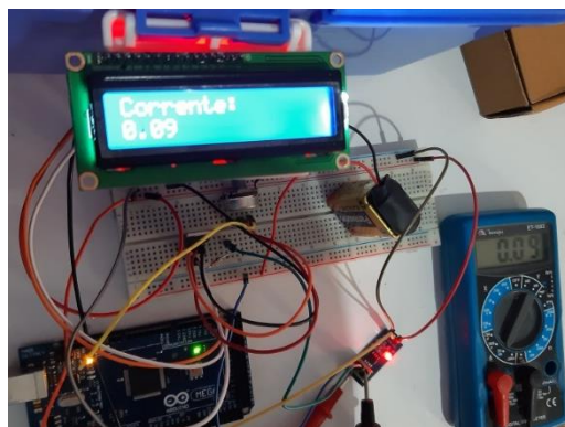
FIGURA 4. Implementação do amperímetro e comparação com a medição no amperímetro comercial.
