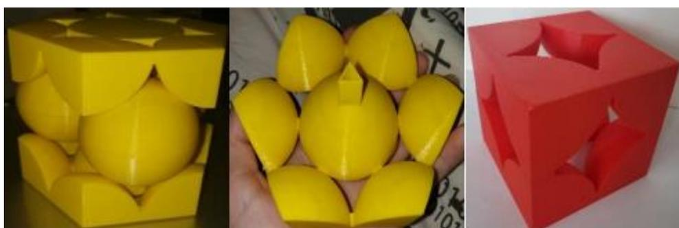
FIGURA 6. Estruturas hexagonal compacta (HC) e cúbica simples (CS). (Fonte: autores, 2018).
