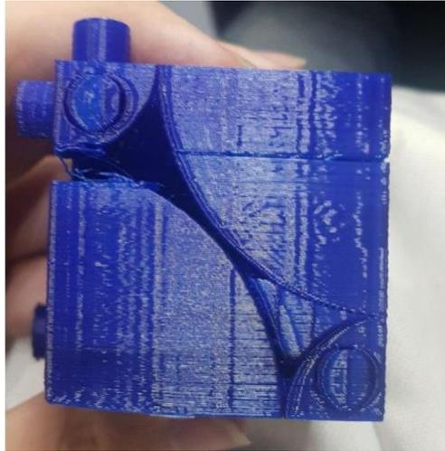
FIGURA 2. Peça com defeito de impressão (CFC). (Fonte: autores, 2018).
