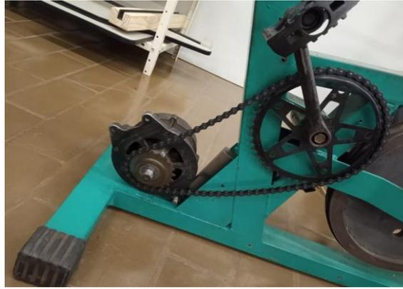
**Figura 5.** Bicicleta ergométrica com alternador, corrente de transmissão e catraca de bicicleta no eixo do alternador
