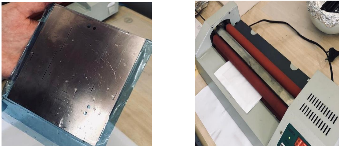
Figura 4 dry film colocado na placa e laminadora
