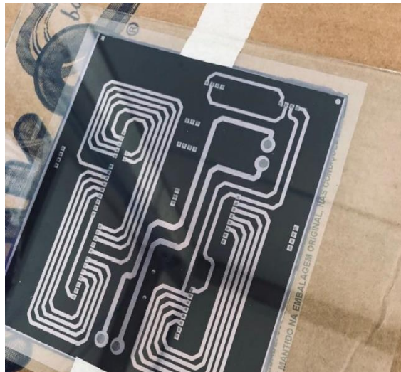
Figura 5 placa com o desenho da face de baixo do circuito após ser exposta a luz ultravioleta.
