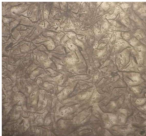
FIGURA 1. Micrografia óptica do ferro fundido cinzento. Os flocos de grafita escuros estão embutidos em uma matriz de ferrita.
