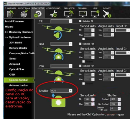
FIGURA 5 - Configuração do canal de disparo do eletroímã no software MissionPlanner . Por padrão da placa ArduPilot, o canal 7 deve ser configurado para essa função.
