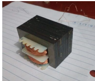
FIGURA 3 - Protótipo de eletroímã desenvolvido.
