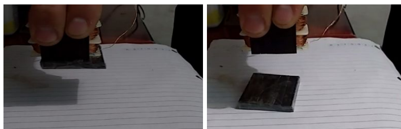
(a) Eletroímã ativado e (b) desativado. FIGURA 7 - (a) Eletroímã ativado e (b) desativado.
