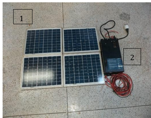
FIGURA 1. Kit de geração energia a partir de células fotovoltaica: 1- Painel solar; 2- Inversor de frequência.
