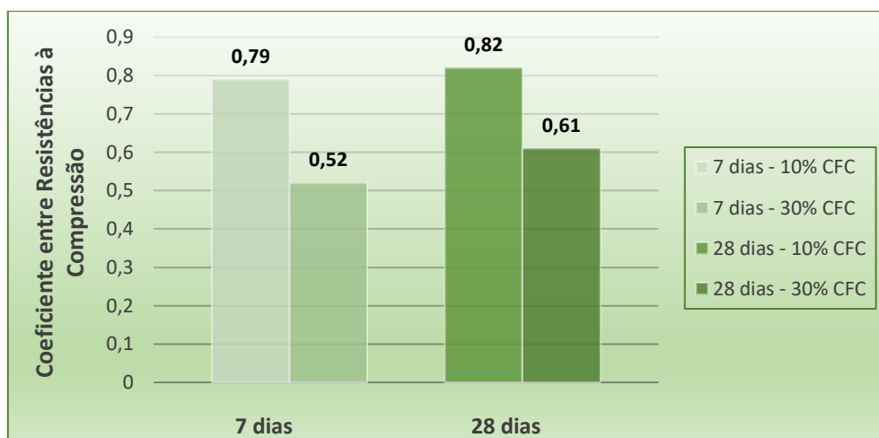
FIGURA 3. Coeficiente entre Resistências à Compressão de Microconcretos para os traços com 10% e 30% de CFC, aos 7 e 28 dias de cura.
