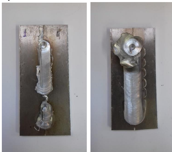
FIGURA 4. (a) Penetração de ombro em 0,2 mm; (b) Penetração de ombro em 0,6 mm Fonte: Autor
