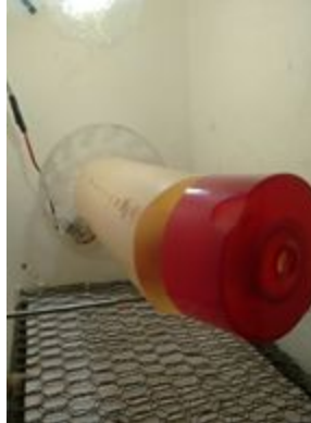
Figura 4: Tubo responsável pela viragem dos ovos
