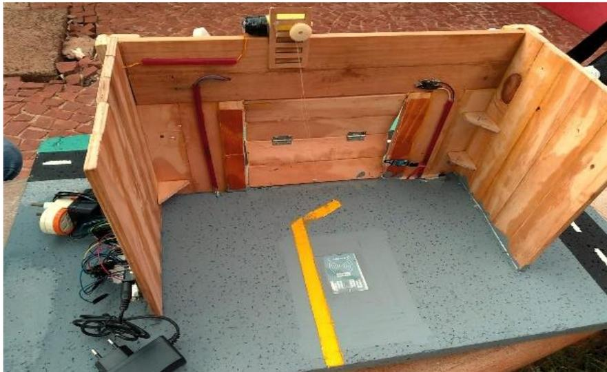
FIGURA 1. Protótipo em escala reduzida para controle de acesso utilizando RFID
