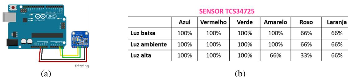
Figura 7 – Experimentos com Sensor RGB TCS34725: (a) Circuito do experimento e (b) Resultados Obtidos
