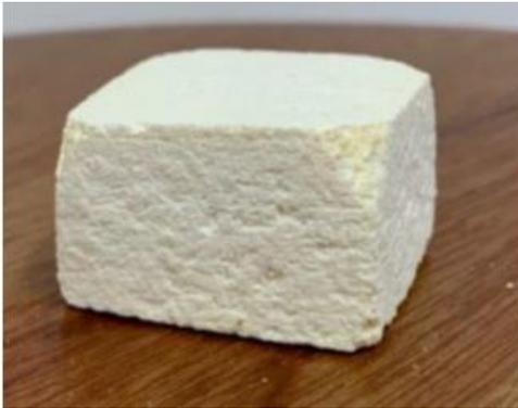
FIGURA 1. Amostra de Aerogél de sílica micrométrica com densidade de  $0,29\text{g/cm}^3$ .
