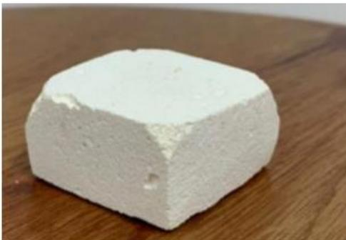
FIGURA 2. Amostra de Aerogél de sílica nanométrica (Aerosil) com densidade de  $0,40\text{g/cm}^3$ .
