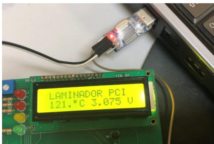
Figura 5: Foto de ensaio para reconhecimento de comportamento do sensor 11L da impressora laser.
