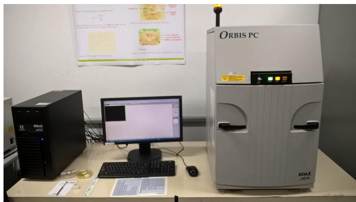
Figura 2: Espectrômetro de Fluorescência de raios X por dispersão de energia modelo ORBIS PC, fabricado pela EDAX/AMETEC.
