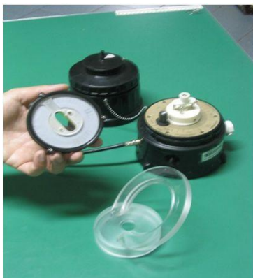
Figura 1: Amostrador Streaker Sampler, fabricado pela PIXE Int. CO., com filtro de PM_{2.5} nele acoplado. Conjunto aberto.
