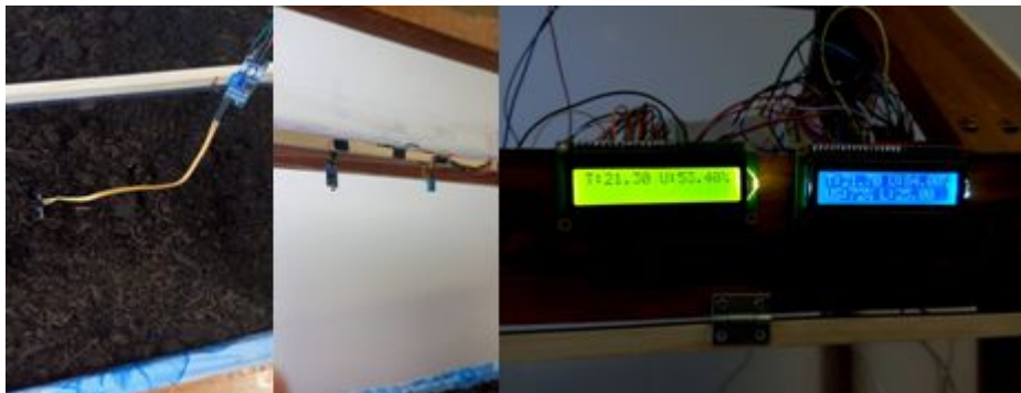
Figura 2- Sensor de umidade do solo (esquerda), sensores de umidade, temperatura e luminosidade (centro) e displays externo e interno (direita).
