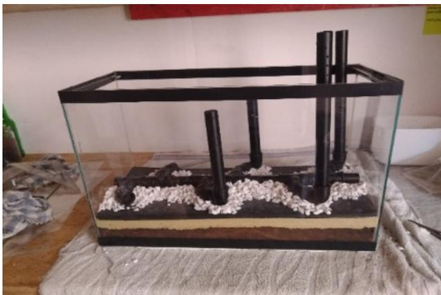
FIGURA 4. Camada central de cascalho e tubulação para drenagem de percolado e gás, montada pela junção da tubulação  $\frac{1}{2}$  polegada cortada de (1x42 cm, 2x15 cm e 2x25 cm) e juntas de  $\frac{1}{2}$  polegada previamente descritos, simulando estrutura do tipo escama de peixe.
