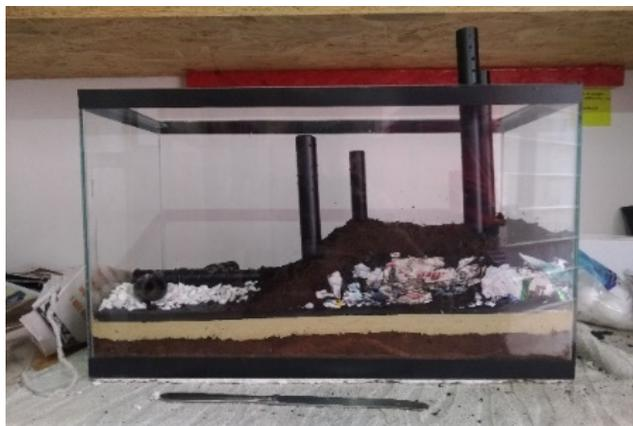
FIGURA 5. Aterramento da primeira célula de lixo compactado, utilizando a segunda folha de plástico transparente, para evitar mistura de camadas.
