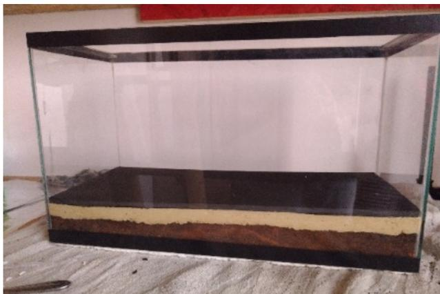
FIGURA 3. Manta de polietileno de alta densidade, representada por EVA preto.
