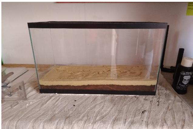
FIGURA 2. Camada de argila com uma folha de plástico transparente entre a terra e argila para evitar mistura de camadas.
