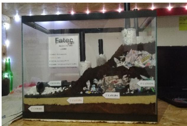
FIGURA 6. Aterramento da segunda célula de lixo compactado, utilizando a terceira folha de plástico transparente, com a construção de dreno com pedrisco, modulando a tela trançada em formato cilíndrico e a prendendo com cola instantânea. As setas indicativas das camadas e legenda foram impressas em folha sulfite.
