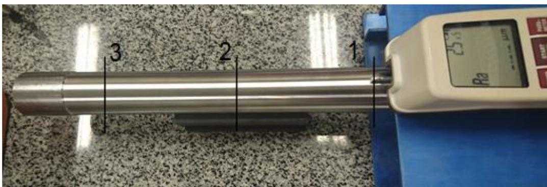
FIGURA 2. Medições de rugosidade após a usinagem
