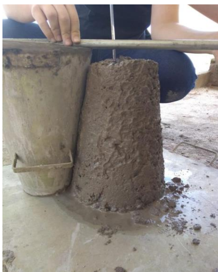
Figura 8 :Ensaio de Slump Test – Diferença em cm de altura.
