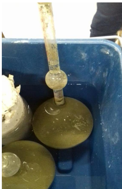
Figura 6 : Banho de água do conjunto cimento com querosene.
