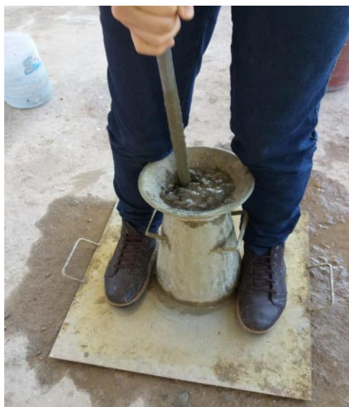
Figura 7: Ensaio de Slump Test – Golpes no preparo.
