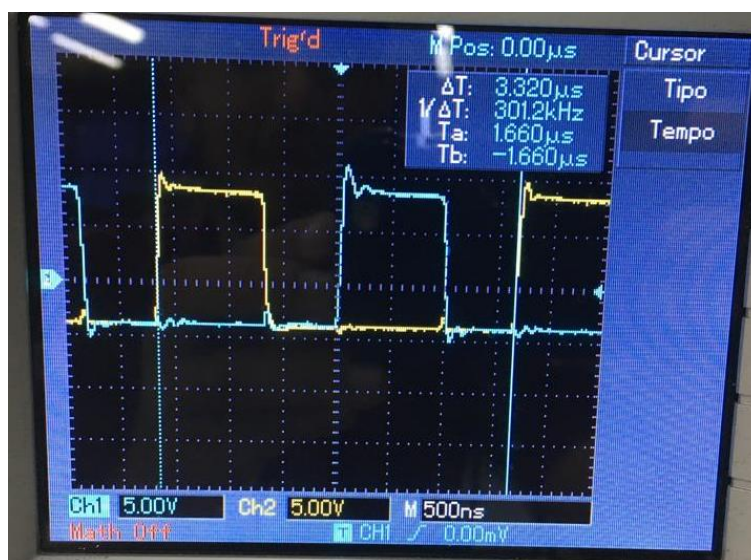
Figura 3 – Formatos de ondas obtidos com SG3525 Fonte: Elaborado pelo próprio autor (2019)
